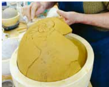
in einer Halbkugel-Form werden Tonplatten gedrückt und verbunden
